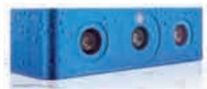
IDS Ensenso 3D立体相机依据“投影纹理立体视觉”原理设计,优势是使其可在多相机模式下工作,捕捉到表面没有任何纹理的图像。体积紧凑且坚固的铝合金外壳带有可锁定的GPIO接口用于触发和闪光,适合工业应用。全新Ensenso N30/N35型号3D立体相机已隆重上市,更支持IP65/67防护等级。
