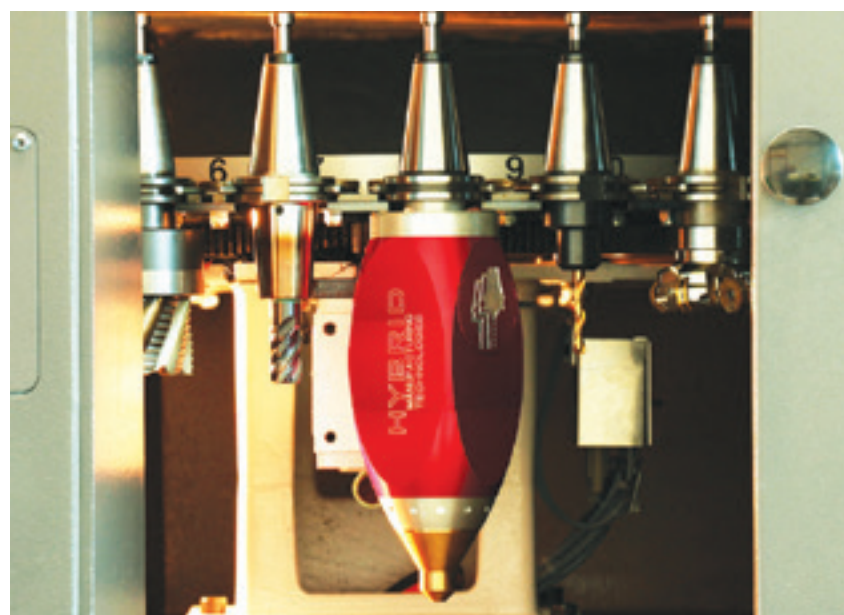
图 4 AMBIT 激光熔覆头在使用过程中被安装在主轴上, 此外便存储在工具库中。
