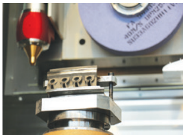
图 1 重新磨平的叶片部分是用 AMBIT 激光头修复以及用 millGRIND 来磨削。
