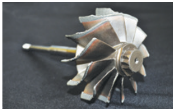
图 3 用混合式数控机床来修复 Cummins 涡轮增压器的叶轮。
